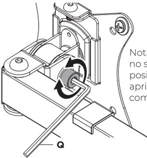
Nota: si la pantalla no se detiene en la posición deseada, apriete los tornillos como se muestra
