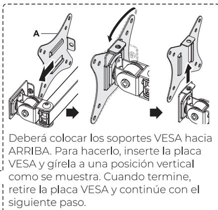
Deberá colocar los soportes VESA hacia ARRIBA. Para hacerlo, inserte la placa VESA y gírela a una posición vertical como se muestra. Cuando termine, retire la placa VESA y continúe con el siguiente paso.
